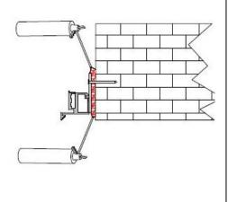
Alu-Zarge Komplett 3-Seitig mittels 2-K PU Schaum hinterfüllen.
