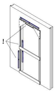
Alu-Zargen waagrecht und Lotrecht ausrichten und mittels Keilen fixieren.
