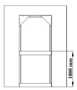
Alu-Zarge Einbauhöhe auf Meterriss einrichten. (Meterriss ist Oberkante der 2.Spreize
